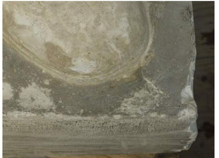
Photo 33 - nettoyage de la chaussure par photoablation
