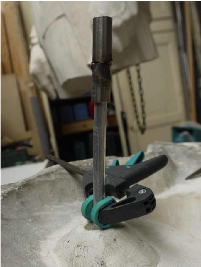
Photo 81 - les hampes en aluminium dans la jambes sont prolongées par un fourreau fileté en inox
